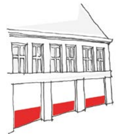
Tilklæbning af 1/3 af vinduesfladen i en facade i stueplan.
